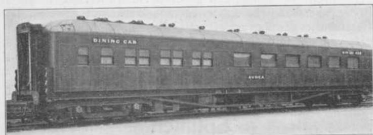
Eetwagen, geheel staalconstructie, gebouwd in de Staatsspoorwerkplaats te Newport, Victoria, Australië.
