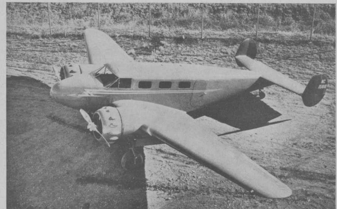
Een tweemotorig Beechcraft vliegtuig dat, met plaatsruimte voor zes passagiers, een uitstekend vliegtuig is voor feeder lines. Kruissnelheid 300 km/u.
