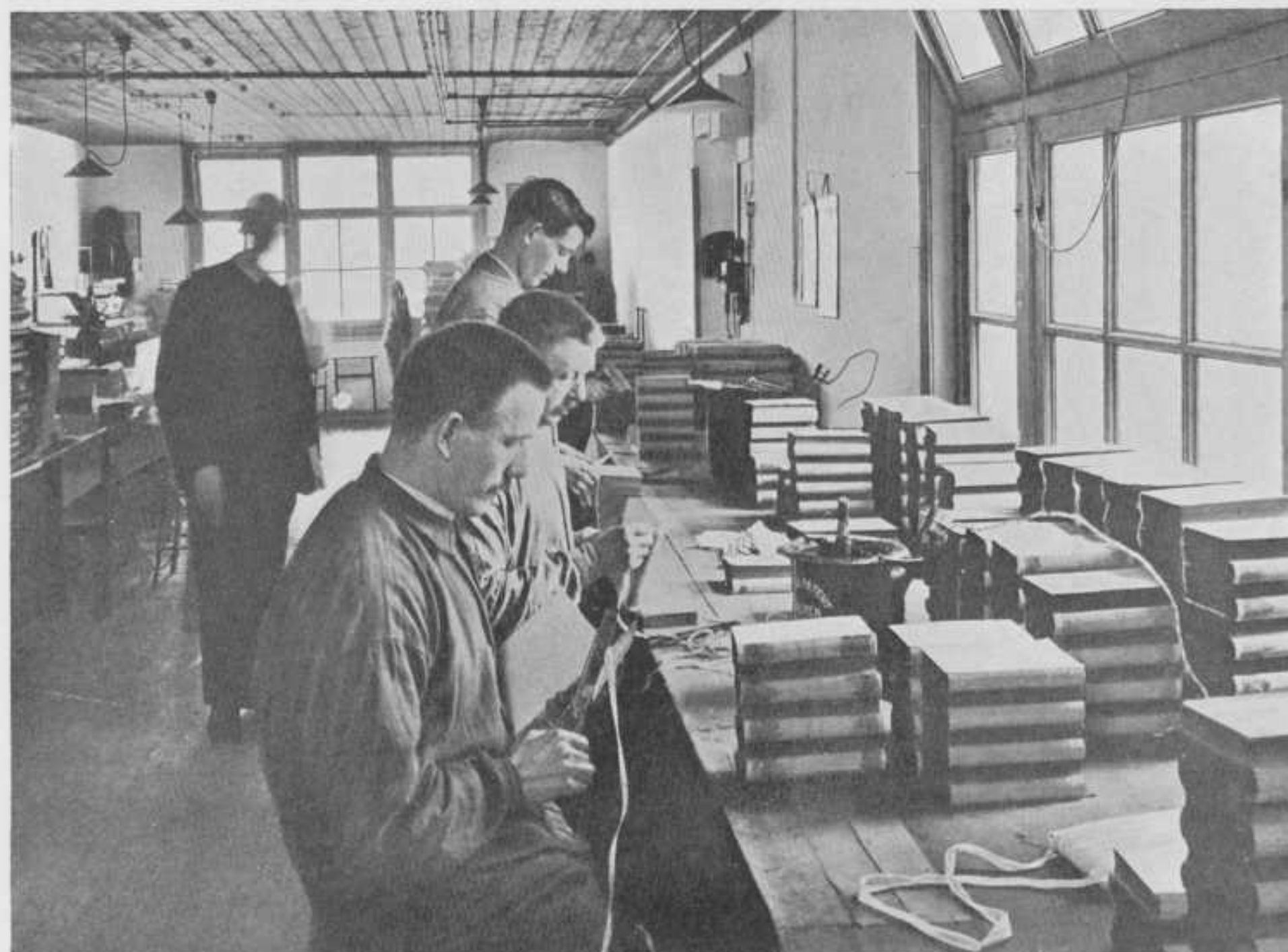
Het kapitalen. Ter versiering en ter meerdere vastheid van de boven- en onderzijde van het boek (kop en staart) wordt hier gaas geplakt, voorzien van gekleurd koord, dat op de boeksneede rust.
