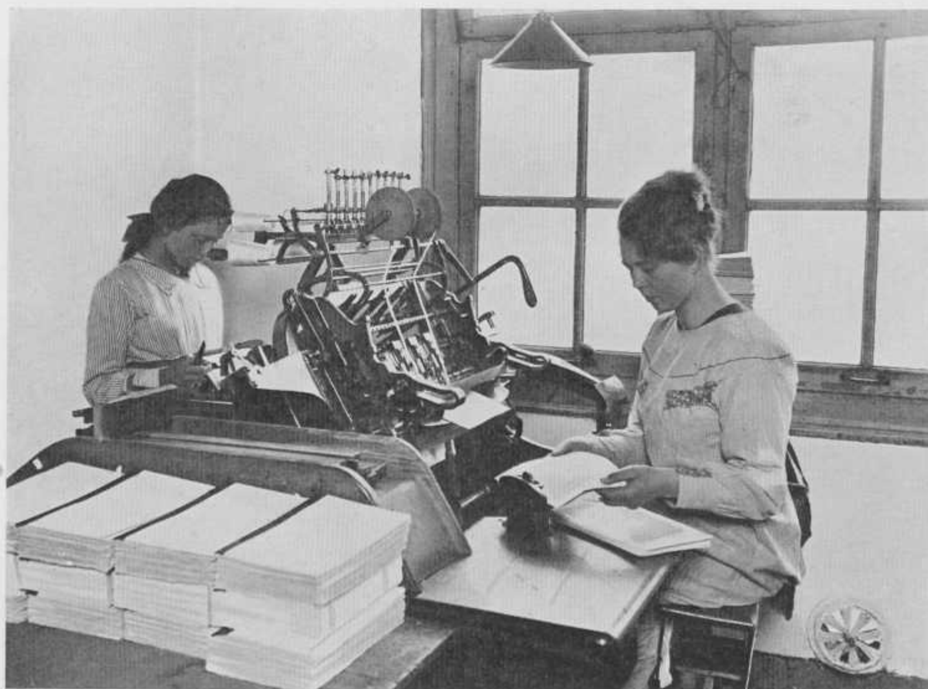
Een naaimachine. De vellen worden met de hand opgelegd, door de machine tot één geheel vereenigd. Achter de machine is een meisje bezig met het van elkaar snijden der verschillende boeken.
