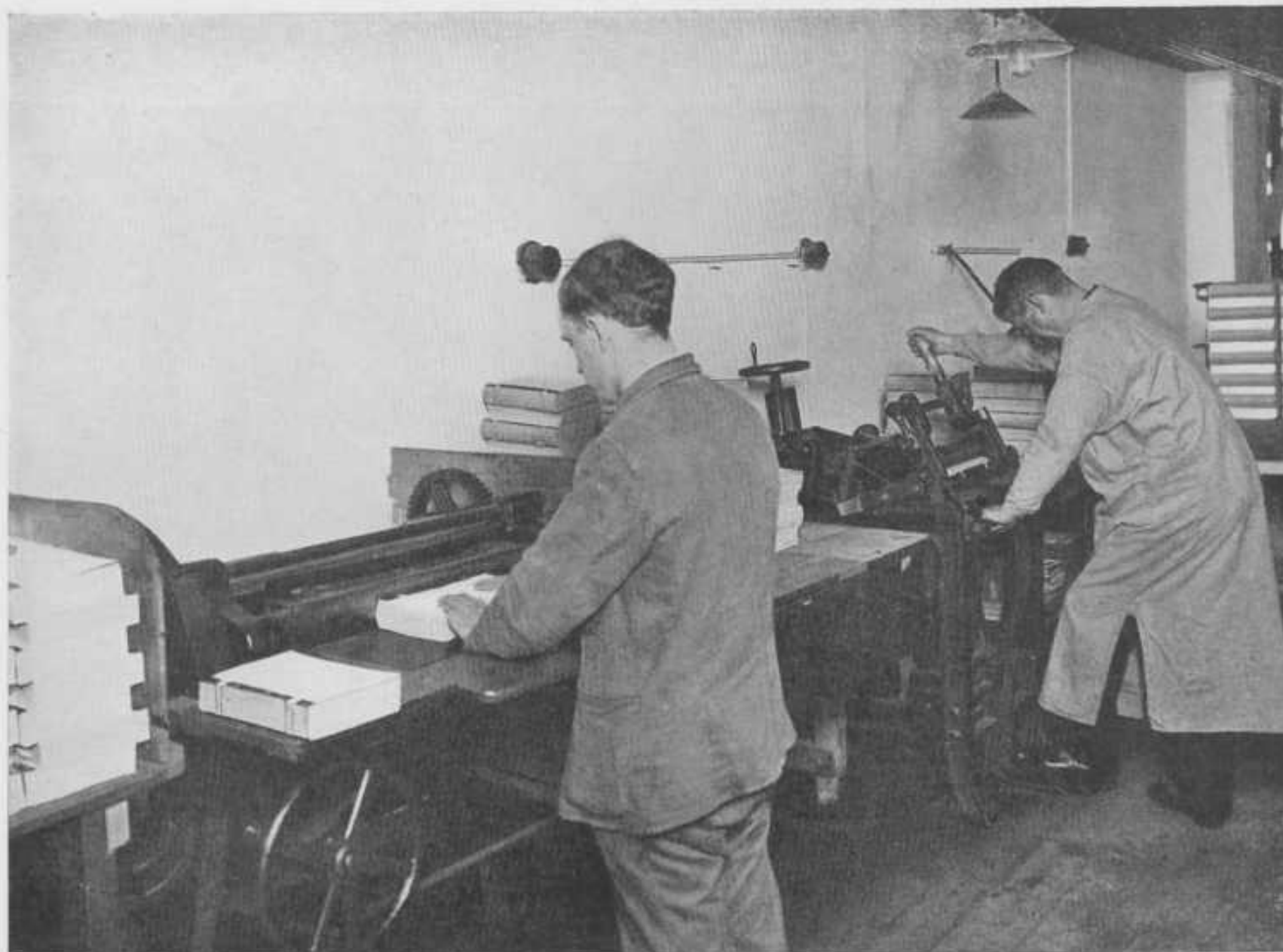
Het rondzetten en kneepen der boeken geschiedde vroeger met den hamer. Thans wordt de ronde rug verkregen door het boek op een ijzeren tafel te leggen, waar op juiste hoogte gesteld, een rol de ronding door persing aanbrengt. Na het rondzetten volgt het kneepen. Hiertoe wordt het rondgezette boek tusschen 2 ijzeren balken geklemd, waarna een ijzeren rol over den rug wordt gehaald, zoodat de kneep, d.w.z. de opstaande kant wordt gevormd, waar het bord van den band tegenaan moet rusten.
