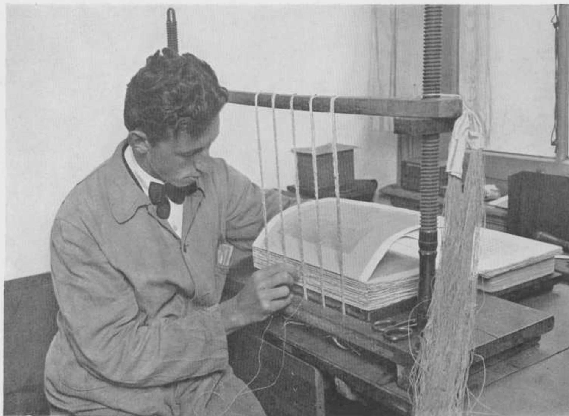
Het naaien met de hand. Enkele boeken worden nog met de hand genaaid op dezelfde wijze als dit eertijds geschiedde. Hier ziet men een boek om touw genaaid, de antieke wijze, waarop ook in vroegere eeuwen de Staten-Bijbels en zware boeken werden genaaid.
