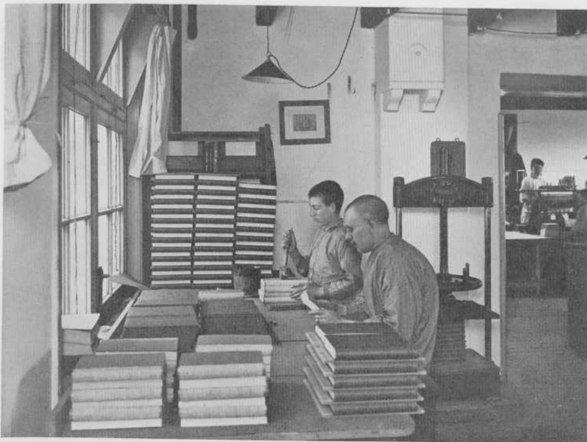
Het in den band zetten. Nadat de banden gestempeld zijn en de boeken na het kapitalen ook met gaas zijn overlijmd en voor zwaardere deelen voorzien zijn van een drierug, worden deze ingezet. Hier ziet men het inzetten met de hand; nadat de ruggen der banden zijn rondgezet, waartoe deze verwarmd worden, worden de platten der boeken met stijfsel aangesmeerd en in den band gelegd, daarna tusschen persplanken in de plet gedroogd, waardoor de verbinding van boek en band tot stand komt.
