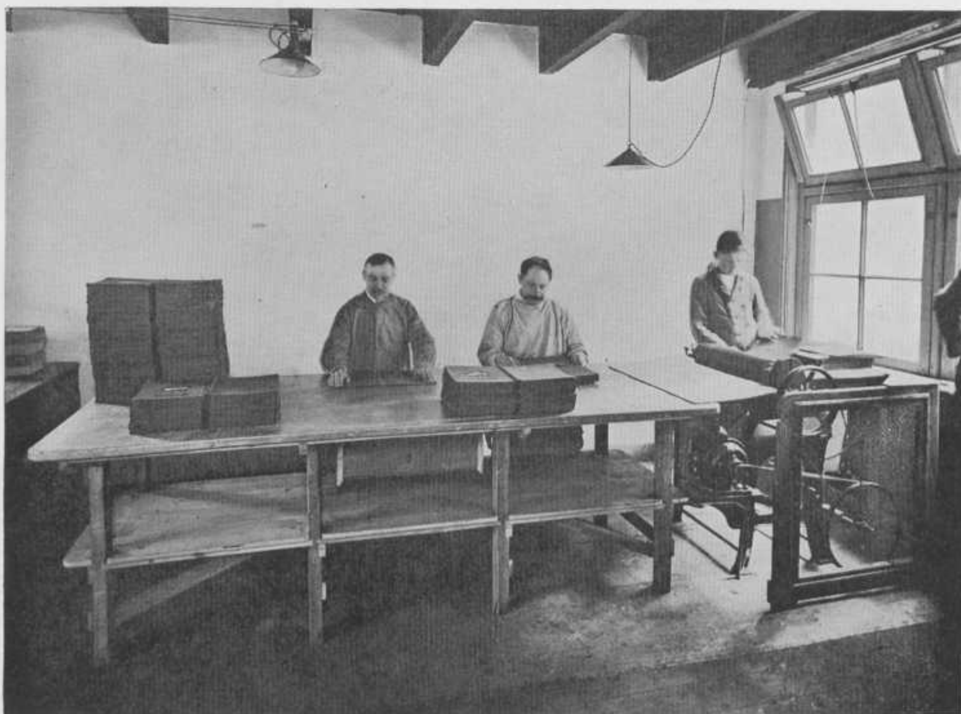
Het maken der banden. De op juist formaat passend gesneden stukken linnen worden op de aansmeermachine gelegd, waar zij door rollen automatisch van warme kleefstof worden voorzien. Hierna worden de cartons ingelegd en het linnen rondom met de hand ingeslagen.
