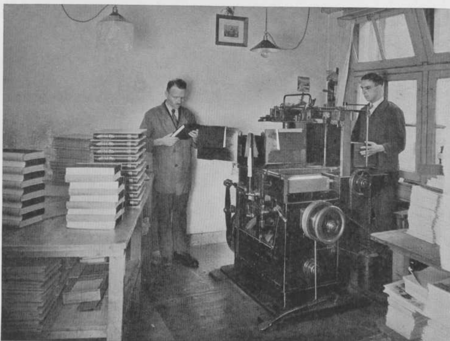
De inhangmachines. Het inzetten der boeken kan ook machinaal geschieden. De banden worden automatisch ingevoerd in de machine, waarna het boek wordt opgelegd. De machine smeert beide boekplatten tegelijk aan, de band wordt door de machine er omheen gelegd en het boek komt na eenigen druk te hebben ontvangen, uit de machine, waarna het in de pletpers verder droogt.
