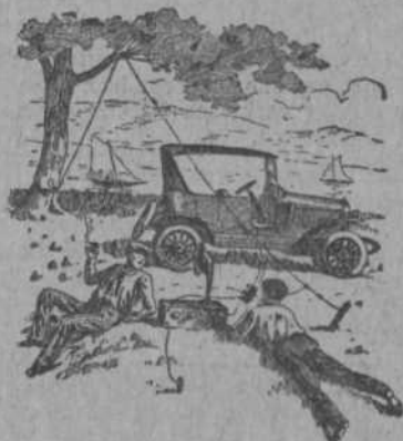
Een eenvoudige ééndraads-antenne van auto — of een gronpikel in de nabijheid — is voldoende.
