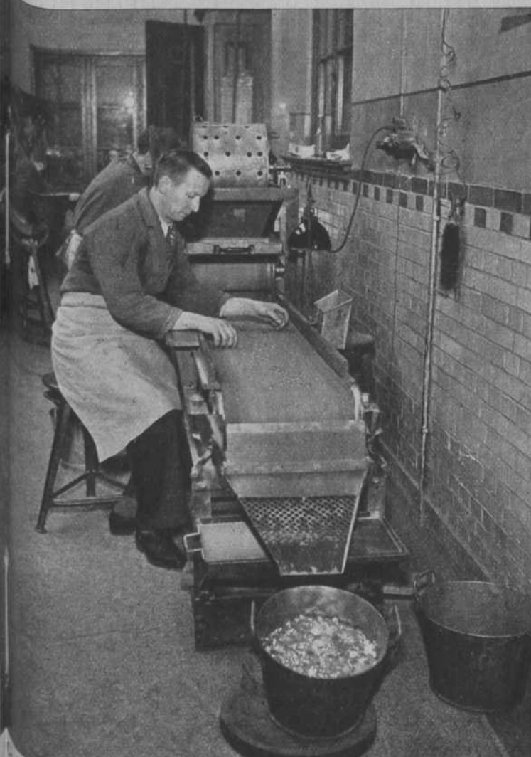
Controle aan den loopenden band. Dit is het „sorteerhoekje”, waar alle halve afgekeurde exemplaren, alvorens naar de muntzaal te gaan, achter gehouden worden. Deze gaan retour naar den smeltoven.
