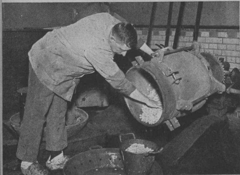
Het geld-in-wording doorloopt verschillende afdelingen, waarbij diverse gloeiovens en baden van bepaalde chemicaliën een rol spelen. Hier ziet men de oogst der kwartjes in de blanchement-afdeling: de glinsterende plaatjes, die nog „gestempeld” moeten worden, zijn door een zuurbad schoongewassen.
