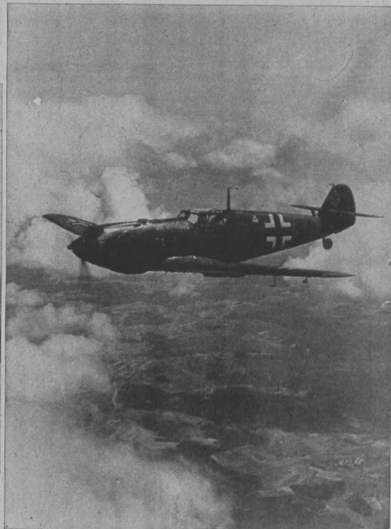
Vooraanzicht van de Me 109. Behalve eenige mitrailleurs in de draagvlakken en in de cockpit heeft het toestel een kanon, waarvan de loop door de kern van den propeller is geleid.
