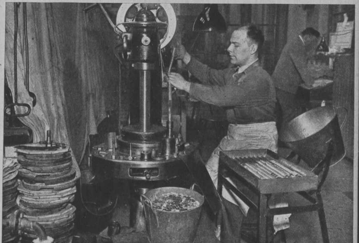
Dit is ook een apart werkje: hier wordt het nog „leege” muntplaatje van het bekende geribbelde randje voorzien.
