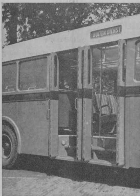
Afb. 3. In- en uitgang met pneumatische bediende vouwdeuren.
