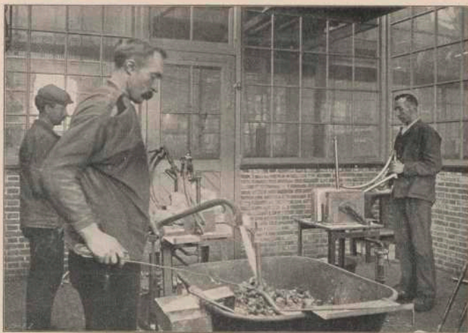
Soldeer-werkplaats, waar de verbindingen der ramen, vorken enz. worden gesoldeerd.
